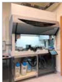
Le robot est un meuble indépendant relié à un système d'extraction de solvant
