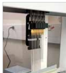
Le système multi-aiguilles permet de traiter 8 échantillons en parallèle
