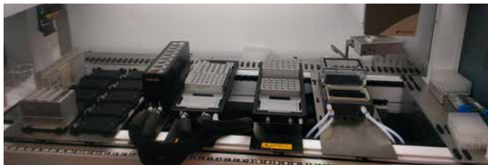
Le plateau multi-portoirs réfrigéré peut s'adapter à différents types de préparation
